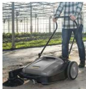
ハンドルを引き上げて、溝にはめ込むだけで3段階に高さの調節が行えます。
